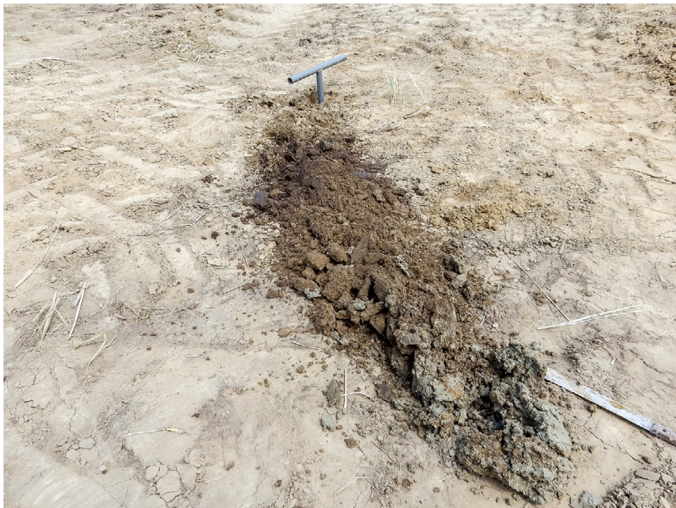
Afb.13. Grondboring locatie voormalig dijktracé voor de dijkdoorbraak. Boorput f.
