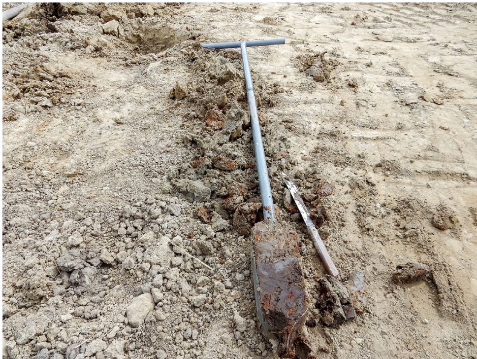
Afb.9. Grondboring voor noordelijk “dijkhoofd”, boorput b.
