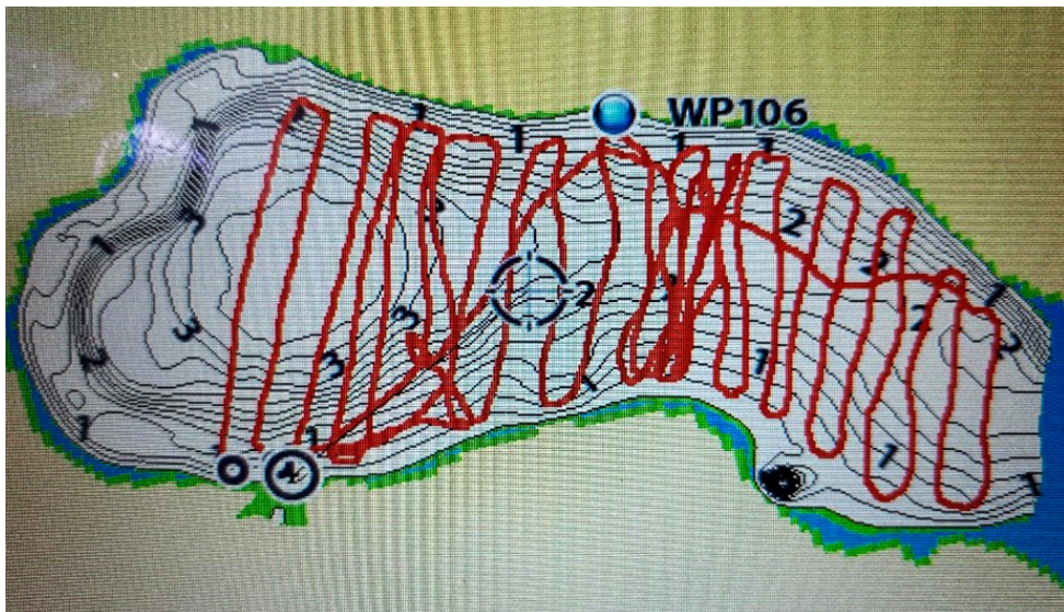
Figuur 5: Schermafbeelding side scan sonar gevaren raaien in noord-zuidrichting naar het oosten (eerste slag)..
